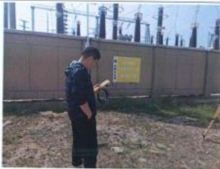
东风变电站北围墙外电磁检测
