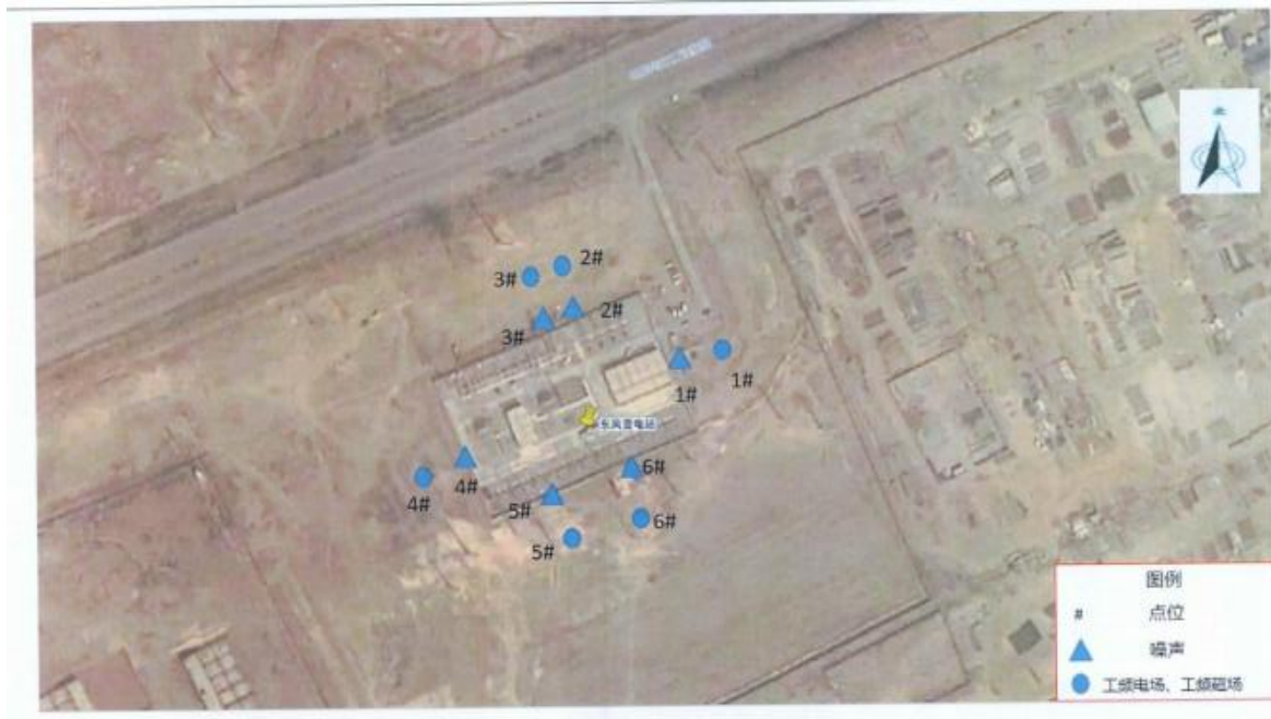
图 2 乌海东风 220 千伏变电站监测点位
