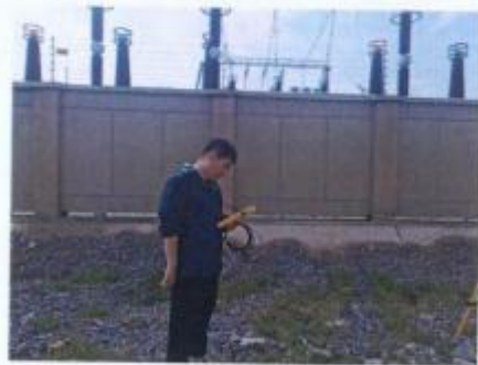
东风变电站南侧围墙外电磁检测
